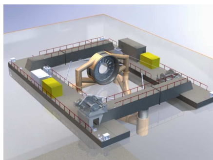
Transport de l'hydrolienne
